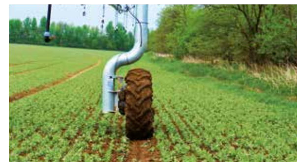
Точное движение по колею благодаря подземному кабелю. Ведущие колеса с возможностью разворота.
