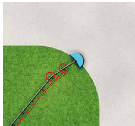
Обмен данными между концевой башней, угловой секцией и центральной башней осуществляется посредством шины CAN.
